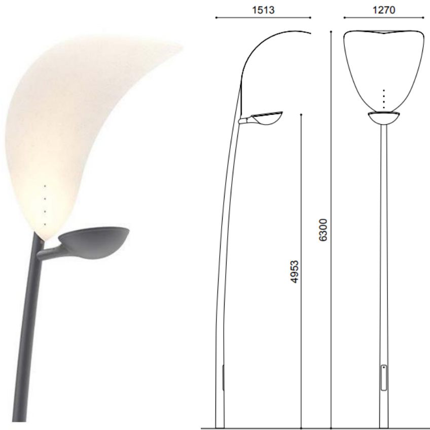
Abbildung 4: Bauform der Leuchte Floris II (Datenblatt Leipziger Leuchten)
