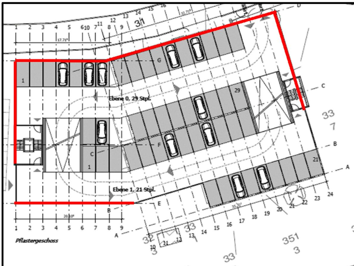
Abb.3: Darstellung der geschlossen auszuführenden Fassaden des Parkhauses
