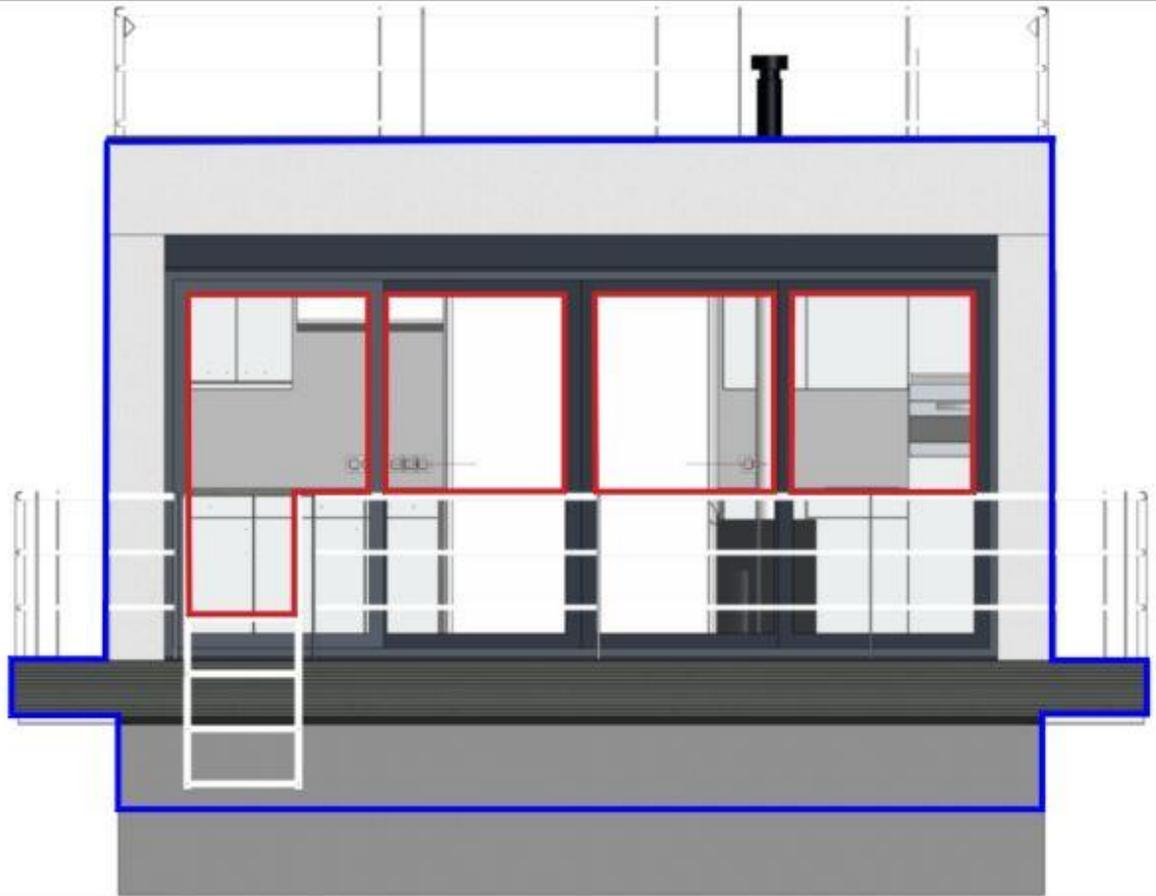
**Abbildung 4: Anteil frei sichtbarer Glasflächen beim FH 44-3 - Stirnseite.**
